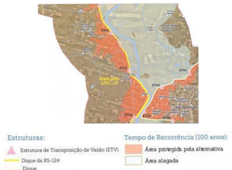
Figura 12. Alternativas estruturais de intervenção proposta para a RS-124 em São Sebastião do Cai.
