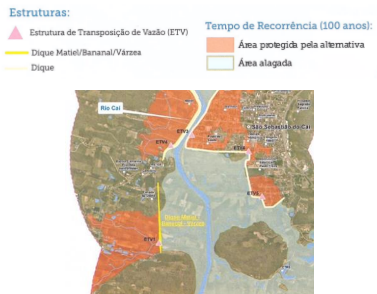
Figura 10. Alternativas estruturais de intervenção proposta para Matiel, Bananal e Várzea em Parci Novo.
